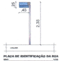
PLACA DE IDENTIFICAÇÃO DA RUA
