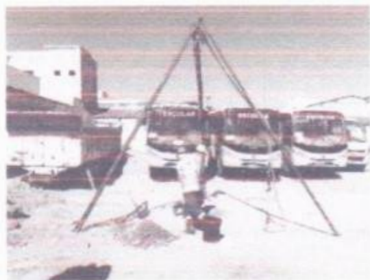
Figura 4: Registro da execução da sondagem à percussão (SP-02) no município de Teixeira - PB.
